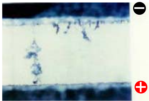
温湿度組合せ（サイクル・低温なし）試験 - 極から発生
